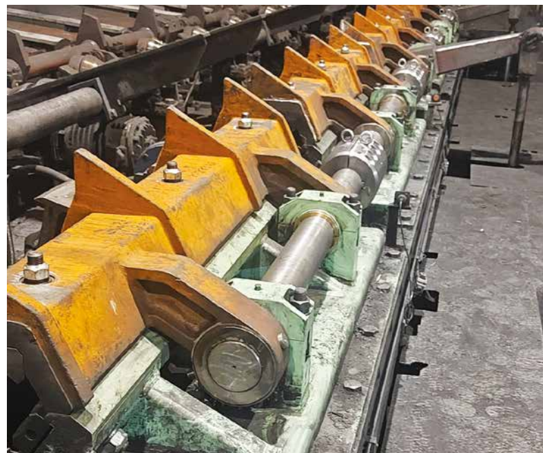
Pohľad na vymenené pohyblivé príklopy na pretlačovacej stolici.
