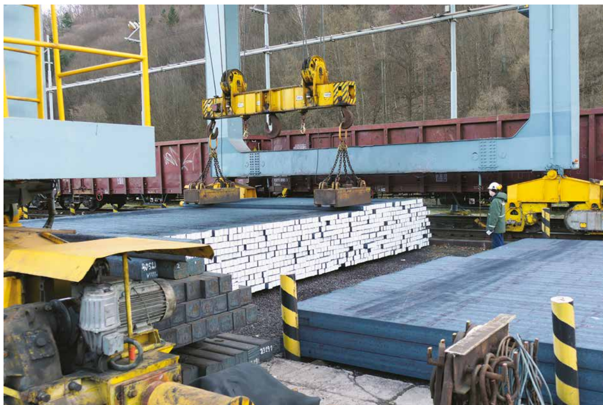
Nakladanie oceľových blokov v areáli starého závodu do pripravených vagónov.
