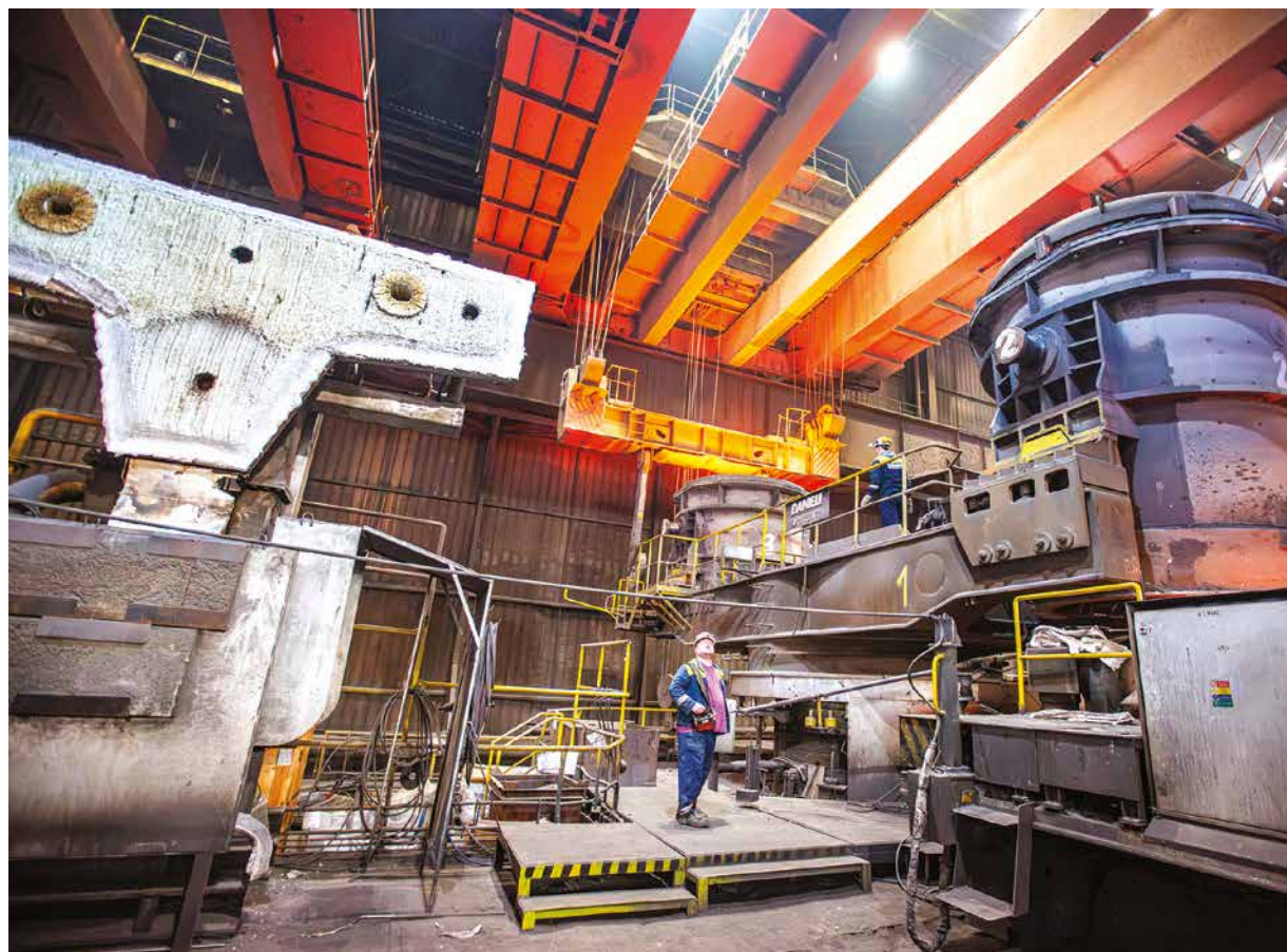
Otočný stojan ZPO pri výmene hlavných paniev počas odlievania ocele.
