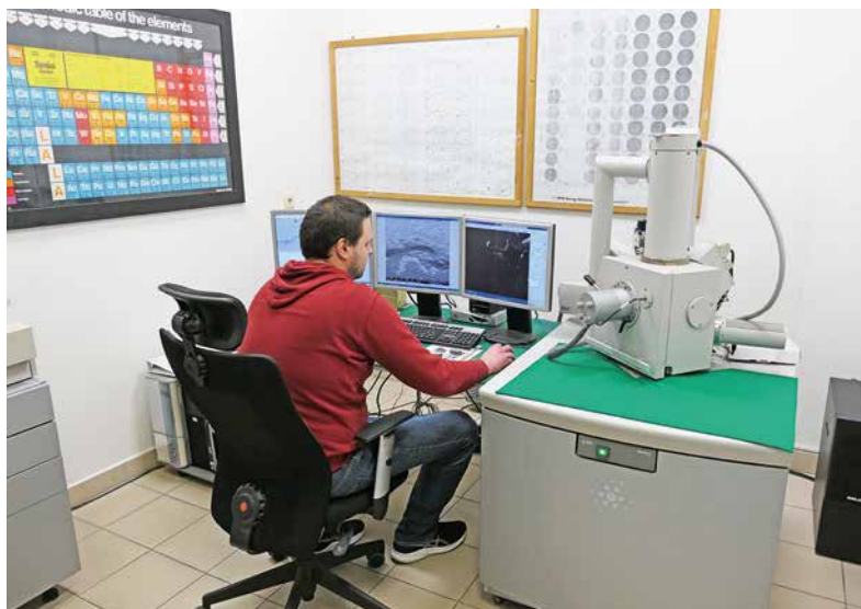
V metalografickom laboratóriu používajú elektrónový mikroskop FEI-INSPEKT. Foto: T. Kubej
