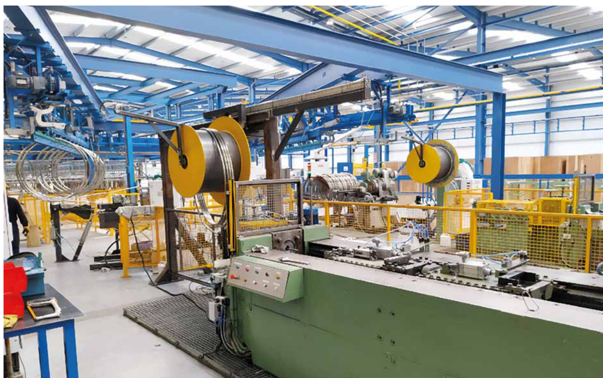
Kontinuálna ťažná stolica Shumag, výroba nerezových rúr v Sant Ramon.
