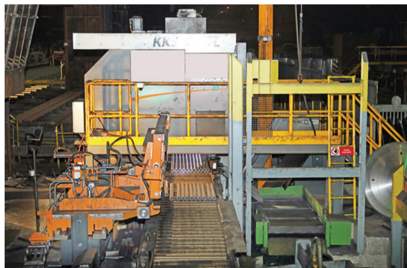
V závere roka 2020 bola vo valcovni bezšvíkových rúr inštalovaná nová tvrdokovová píla.
