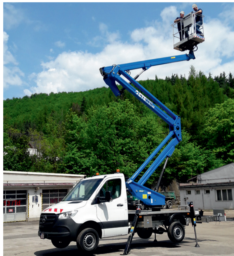
Mobilná pracovná plošina na automobilovom podvozku Mercedes-Benz Sprinter. Foto: PK
