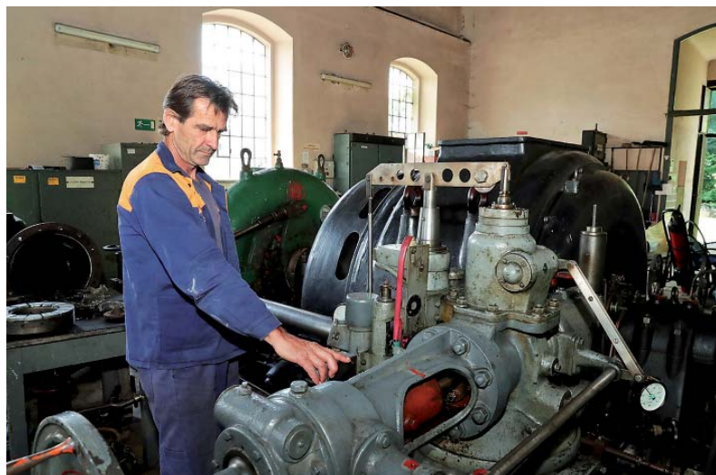
Manipulant pri nastavovaní regulátora turbíny.
