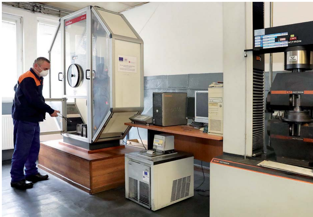
Ing. Ján Šteller v mechanickej skúšobni, chaupy kladivo RKP 450, vykonávanie skúšok rázom v ohybe.
