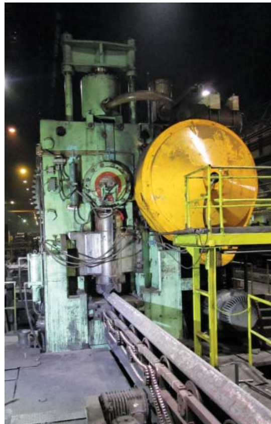
Pohľad na novú nožnicu Lindemann 2200 MP so strihanou vsádzkou
