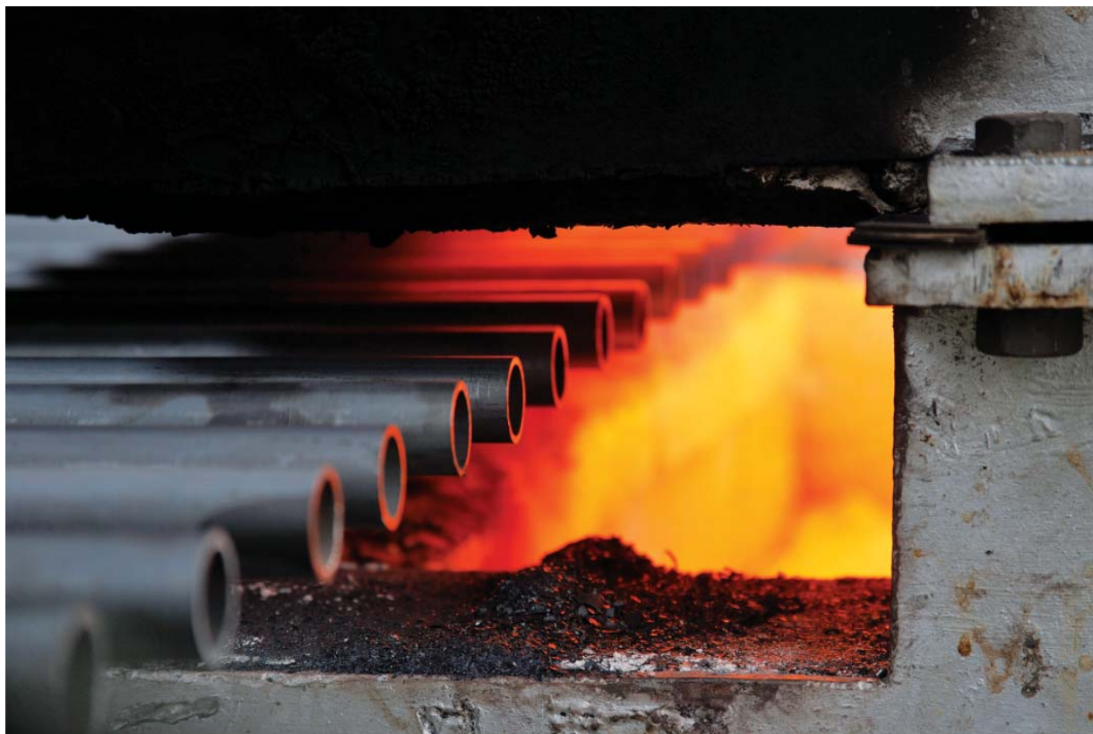
Štrbinová pec na hrotovačke v ťahárni rúr objektívom I. Kardhordovej
