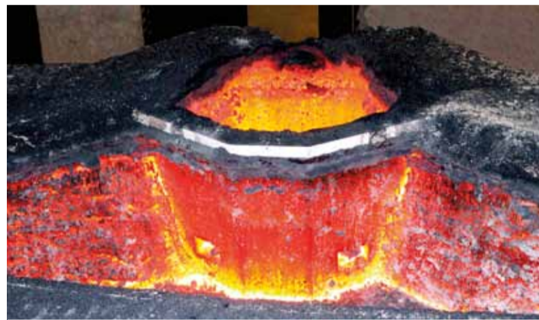
Monolitická vložka po odliatí 17-tavbovej sekvencie.
