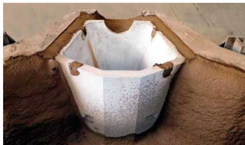
Monolitická vložka po osadení v medzipanve
