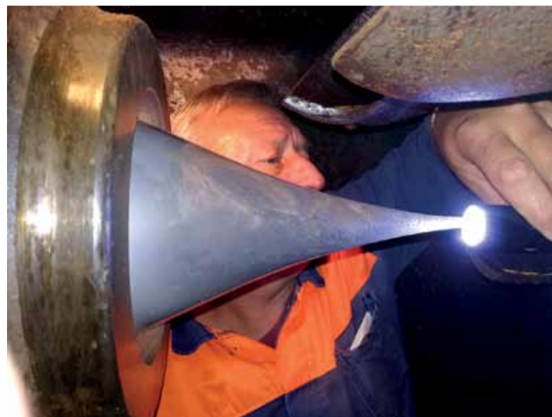
Kontrola ihlového uzáveru TG2 v HC Jasenie
