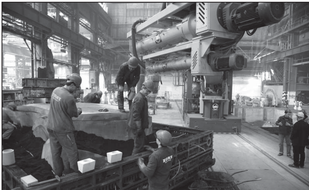
Metalurgický závod - v minulom roku bolo do prevádzky uvedené zariadenie na výrobu foriem na odliatky s využitím furanových formovacích zmesí. F: J. Šindelka
