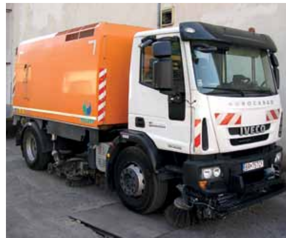
Dvojnápravové vozidlo, na podvozku IVECO EURO CARGO, so zamediacou nadstavbou TRILETY
