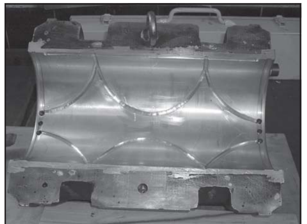
Pohľad na rozobraté ložisko veľkej turbíny v HC Jasenie
